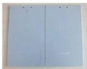
Hliníkové panely po 25 cyklech NORDSOK M-501
