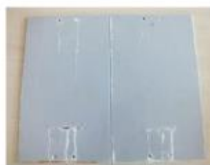
Panely HDG pozink po 25 cyklech NORDSOK M-501
