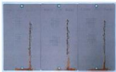
Ocelové panely po 1440 hod testu slané mlhy
